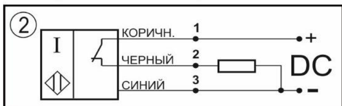
Схема соединения Нормально-замкнутый контакт
