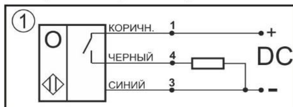
Схема соединения Нормально-разомкнутый контакт
